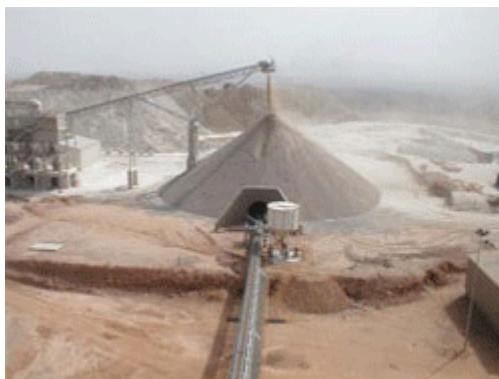
Gebrochener Erzhaufen und Förderband zur Anlage, ROM-Becken im Hintergrund
