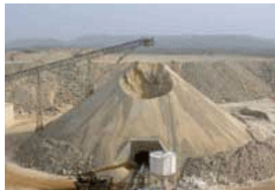
Abbildung links: Lager für gebrochenes Erz Abbildung rechts: Erster Barren aus dem Elutionskreislauf
