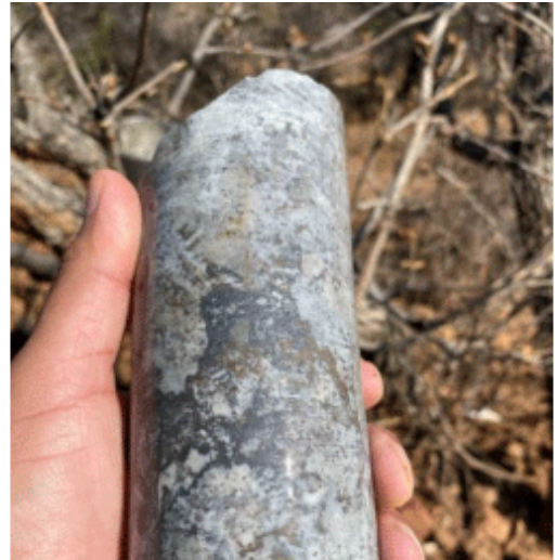
Foto 2: SM20-14 Bohrkern bei 182,8 m 301,44 g/t AgÄq (+9 Unzen) PLUS 2,09% Pb PLUS 5,51% Zn
