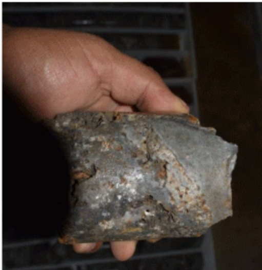
Foto 1: SM20-15 Bohrkern bei 212,4 m mit Gehalt von 2,269 kg AgÄq (72 Unzen) PLUS 1,21% Pb PLUS 2,8% Zn
